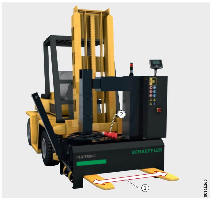
Ilustr. 22 Transport nagrzewnicy HEATER400 oraz HEATER800
